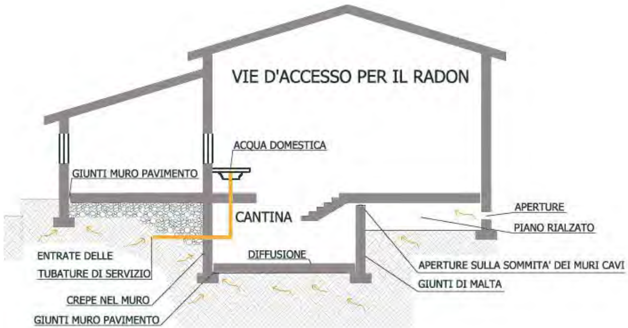
Figura 5: vie d'accesso per il radon
