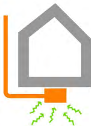
Figura 13: depressione del sottosuolo tramite pozzetto.
