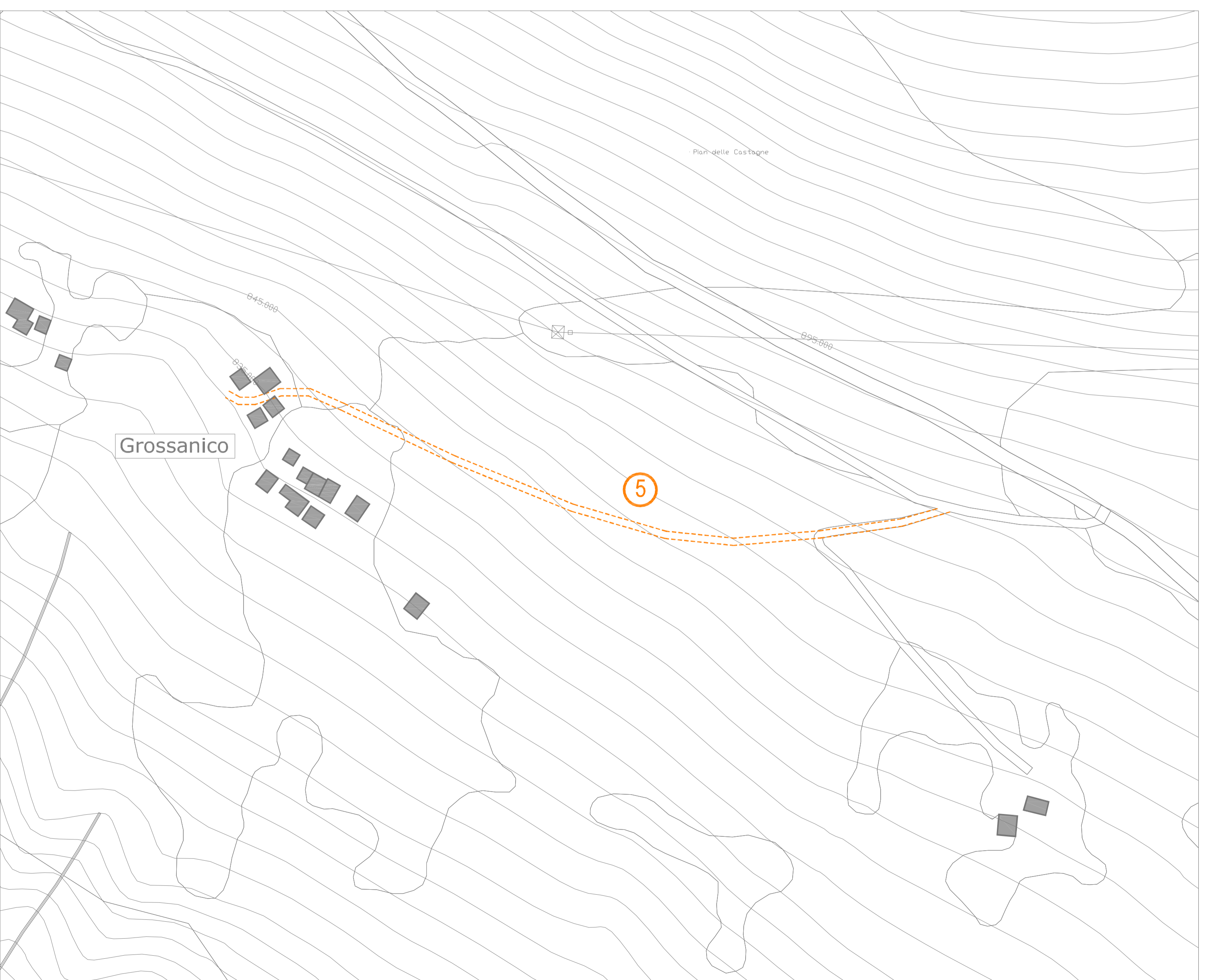
5 Dosso del Liro (localita' Grossanico) Nuova tracciato agro-silvo-pastorale / Realizzazione di un tracciato carrabile con pavimentazione in calcestre che colleghi la Localita' Grossanico (o Crosanico) alla strada carrabile esistente (257 metri lineari circa).
