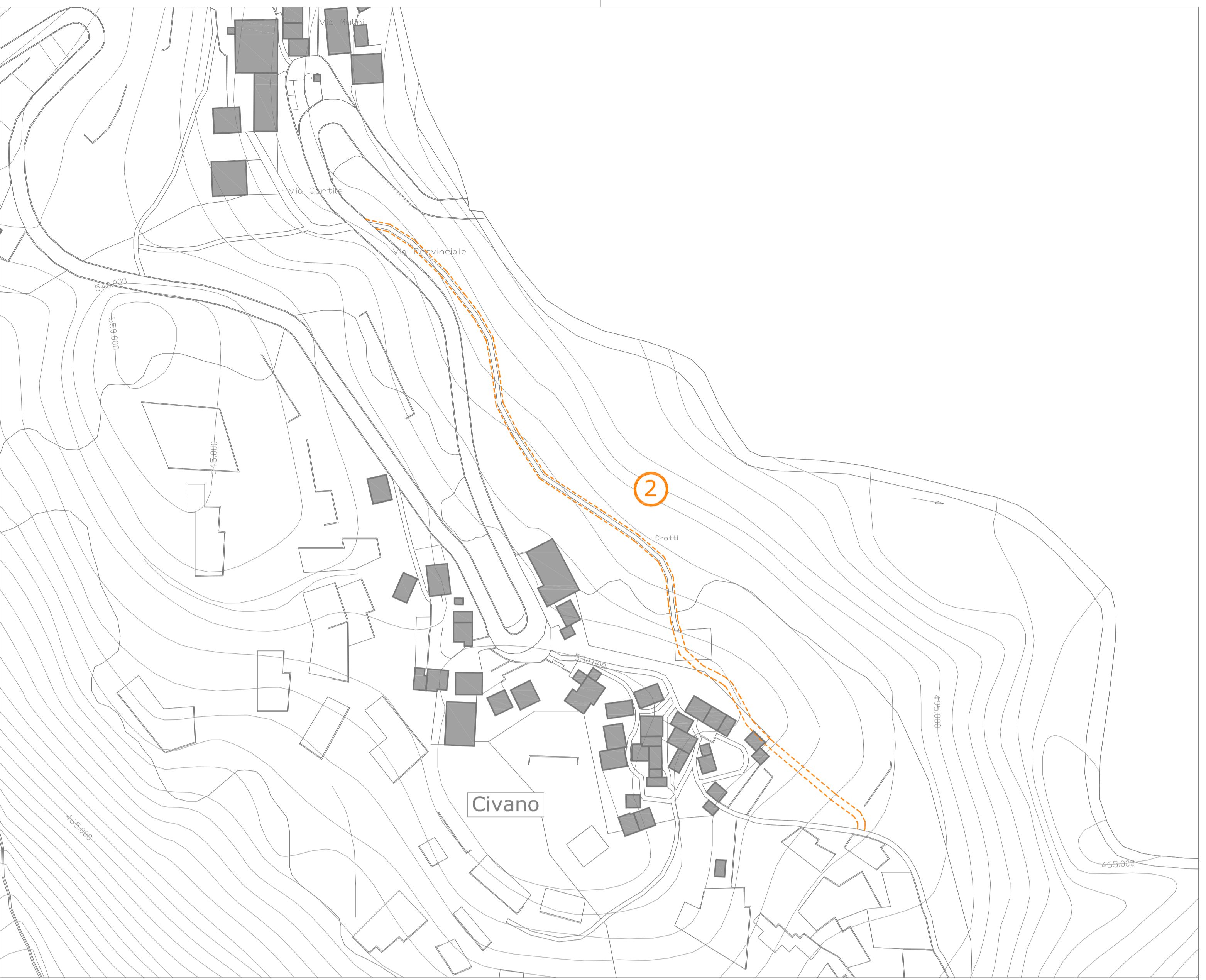
2 Dosso del Liro (Localita' Civano) Realizzazione di un nuovo tracciato carrabile con pavimentazione in calcestre in Localita' Civano mediante l'allargamento di un tracciato pedonale esistente. Superficie di progetto 280 metri lineari (circa).
