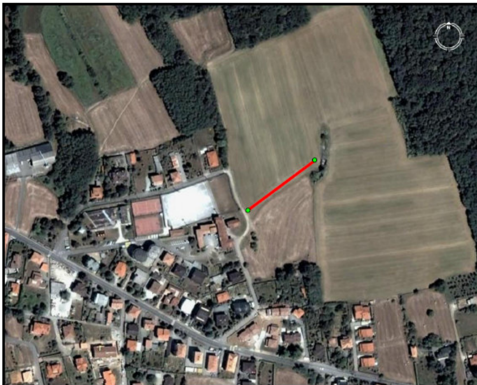
Inquadramento territoriale generale da foto satellitare con ubicazione degli stendimenti; sopra : stendimento ReMi1 (settore occidentale); sotto : stendimento ReMi2 (settore orientale)
