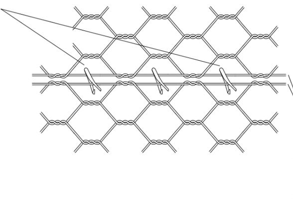
Ancoraggio d'attacco lungo la pendice e collegamento delle funi del reticolo di contenimento
