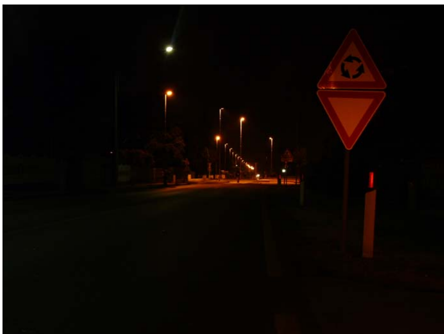
Via per Cornate: percezione notturna. Sono visibili due differenti tipologie di sorgente luminosa: al sodio ad alta pressione e ai vapori di mercurio.
