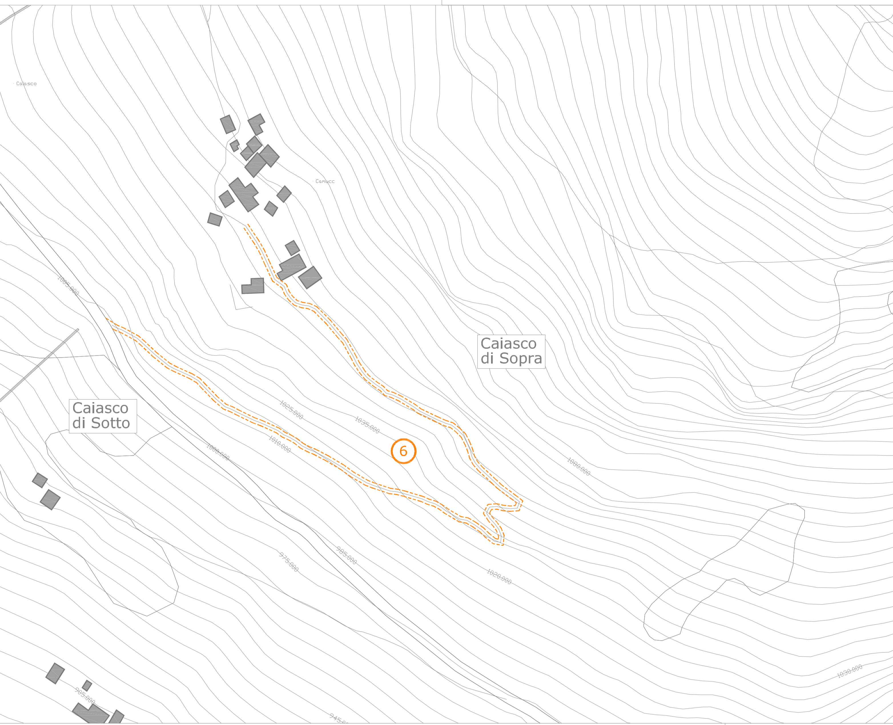
6 Dosso del Liro (localita' Caiasco di Sopra) Nuova tracciato agro-silvo-pastorale / Realizzazione di un tracciato carrabile con pavimentazione in calcestre attraverso l'allargamento del tracciato pedonale esistente al fine di collegare la Localita' Caiasco di Sopra alla strada carrabile esistente (540 metri lineari circa) SCALA 1:1000
