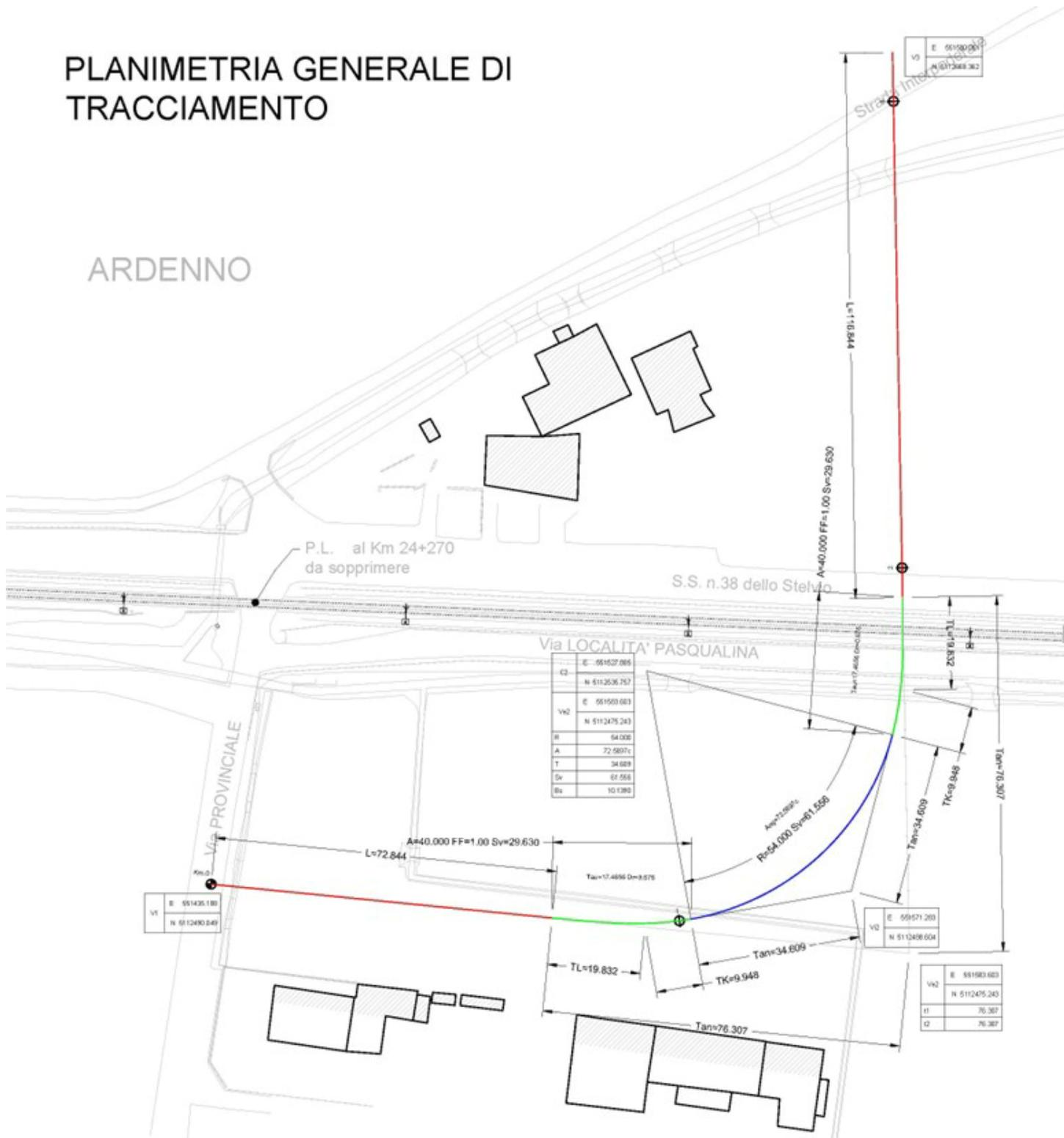
Il tracciato inizia a sud della linea ferroviaria tramite un'intersezione a "T" con Via Provinciale e prosegue con una curva a 90° in direzione nord sottopassando in ordine la strada Pasqualina, la ferrovia e la SS 38 e risalire per superare il canale Guicciarda, fino ad innestarsi a "T" con la futura viabilità complementare secondaria a carico di ANAS.
