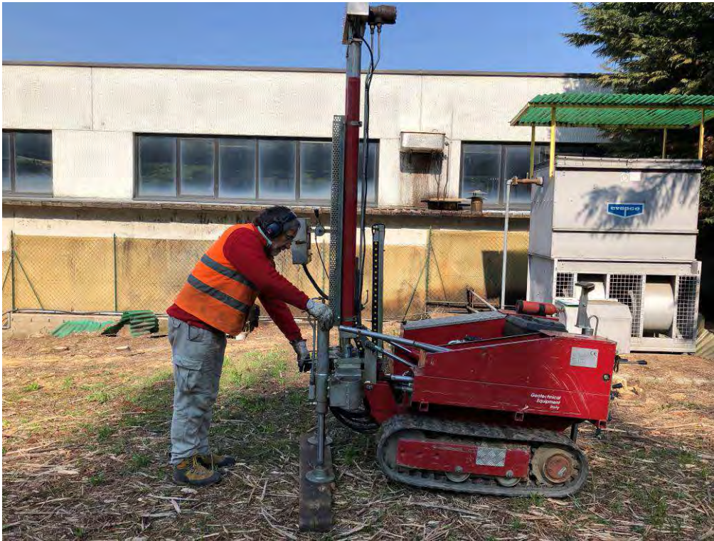
Foto n. 7: Esecuzione prova penetrometrica Scpt
