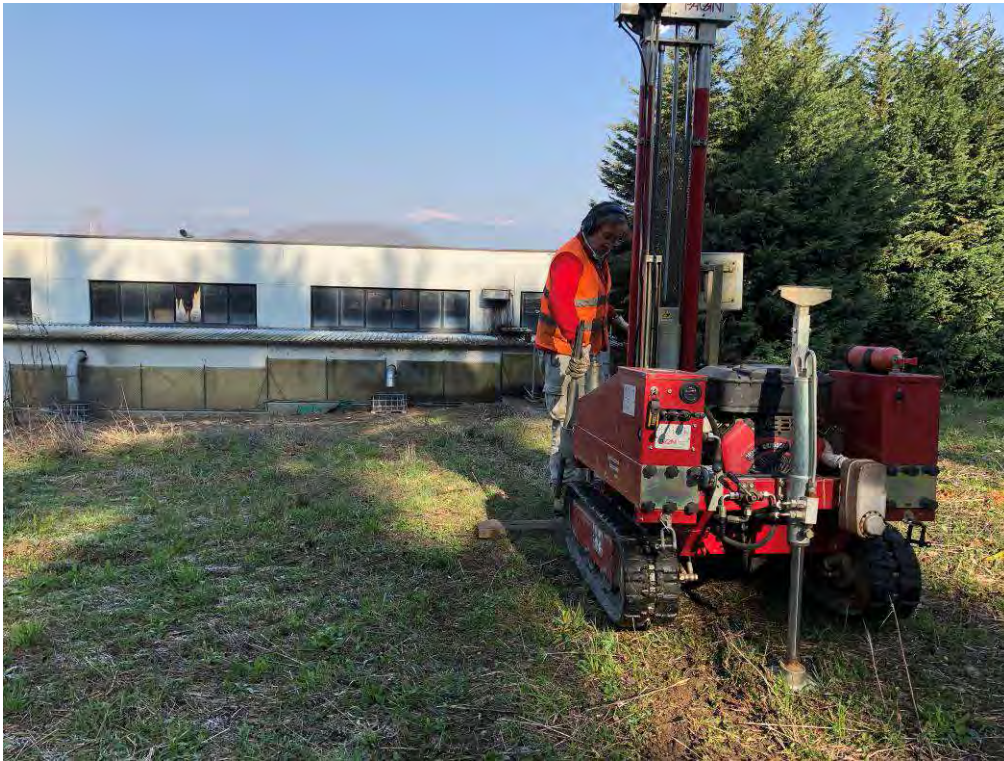
Foto n. 5: Esecuzione prova penetrometrica Scpt
