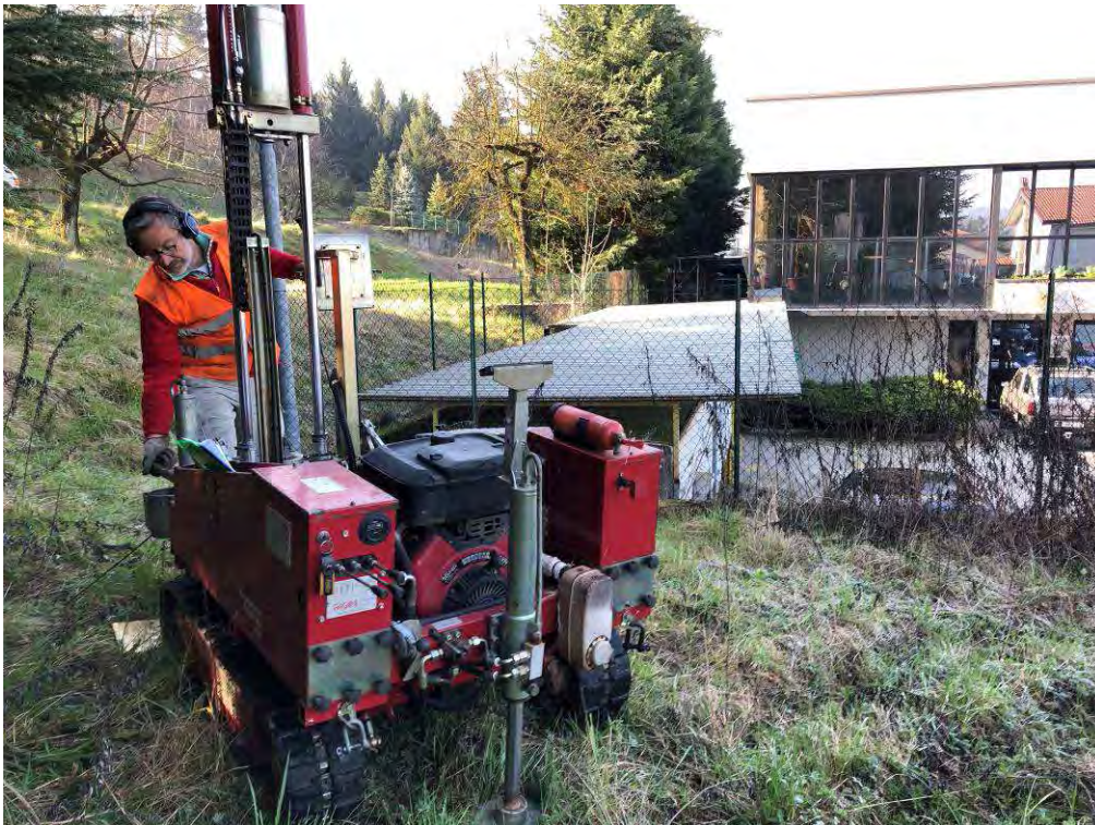
Foto n. 4: Esecuzione prova penetrometrica Scpt
