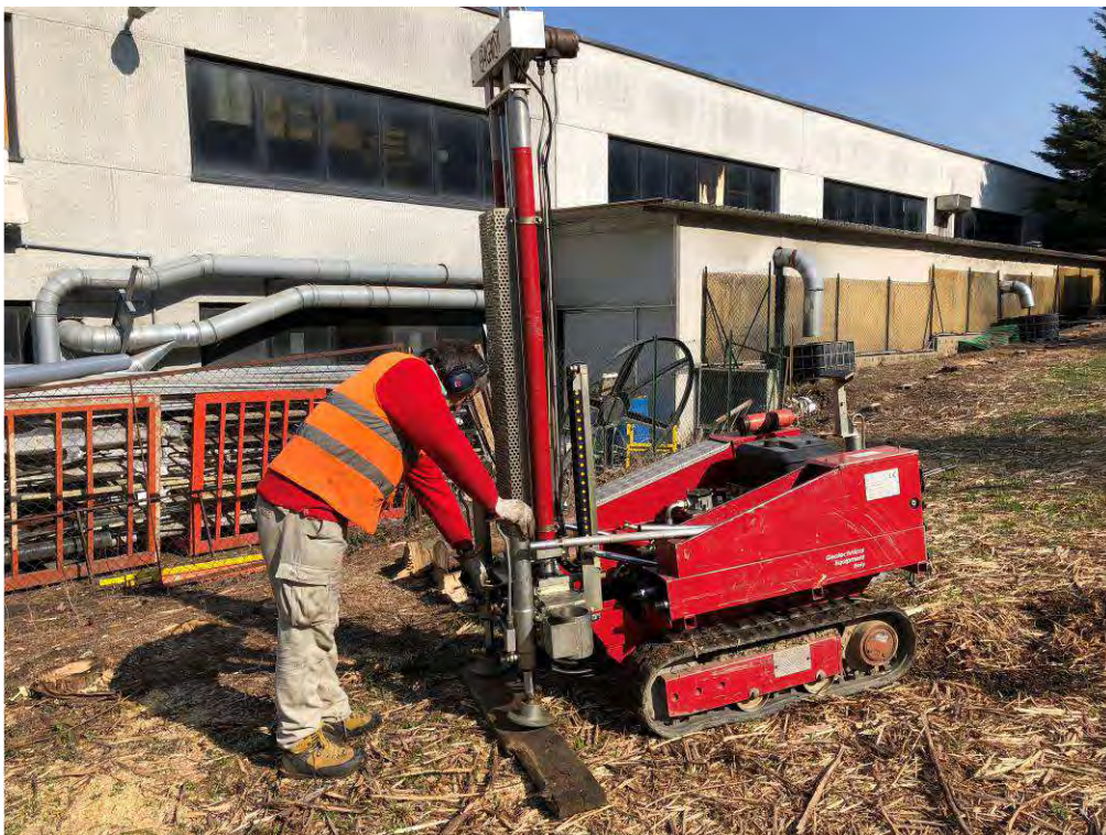
Foto n. 8: Esecuzione prova penetrometrica Scpt
