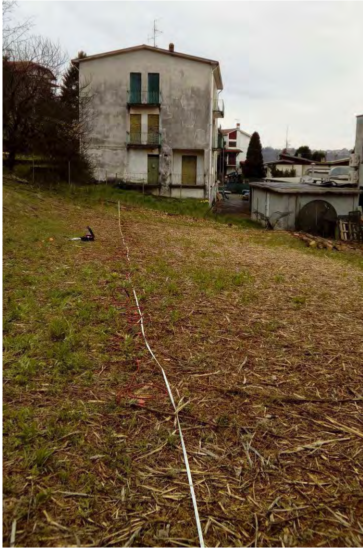
Foto n. 9: Esecuzione Indagine Masw
