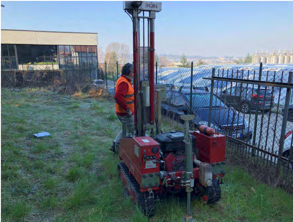
Foto n. 3: Esecuzione prova penetrometrica Scpt
