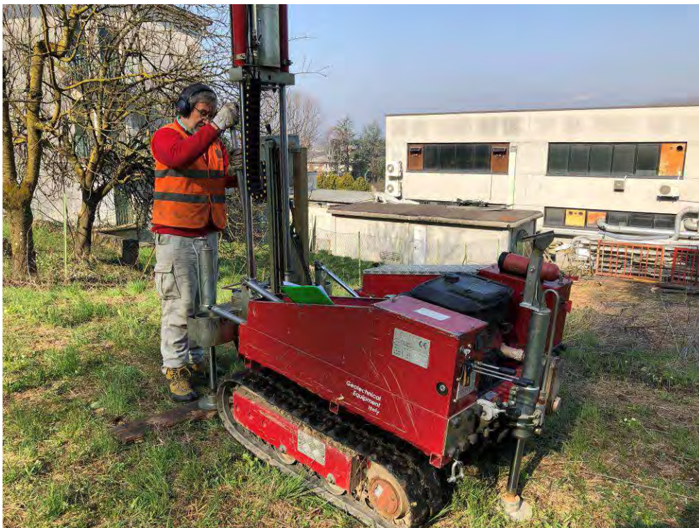
Foto n. 6: Esecuzione prova penetrometrica Scpt
