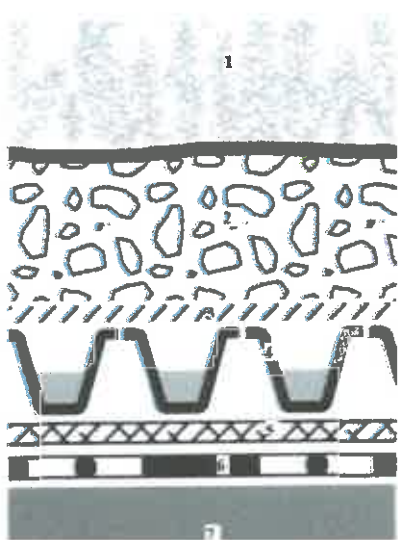
Figura 1: Stratigrafia tipo per verde pensile estensivo con elementi prefabbricati (da ISPRA)
